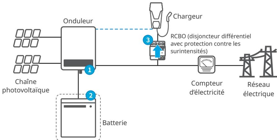
**Étape 1** Allumez les interrupteurs CA et CC côté onduleur.
