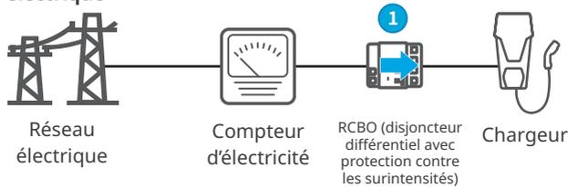
Activez le RCBO entre le chargeur et le réseau électrique.
